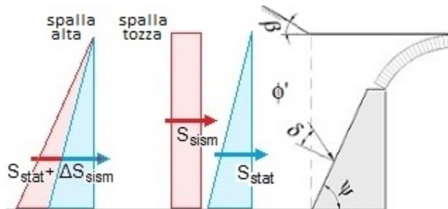
Fig. 2.1.11. Spinte del terreno nei casi di spalla alta e di spalla tozza
