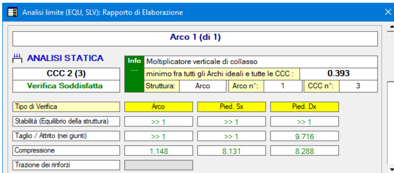
Fig. 2.1.32. Risultati Stato Attuale, Analisi Statica, CCC 2. Report sui moltiplicatori di collasso
