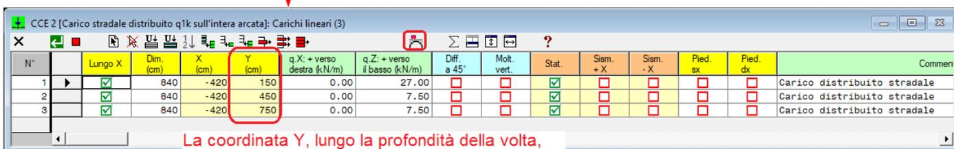
La coordinata Y, lungo la profondità della volta, indica la posizione del carico per le diverse corsie
