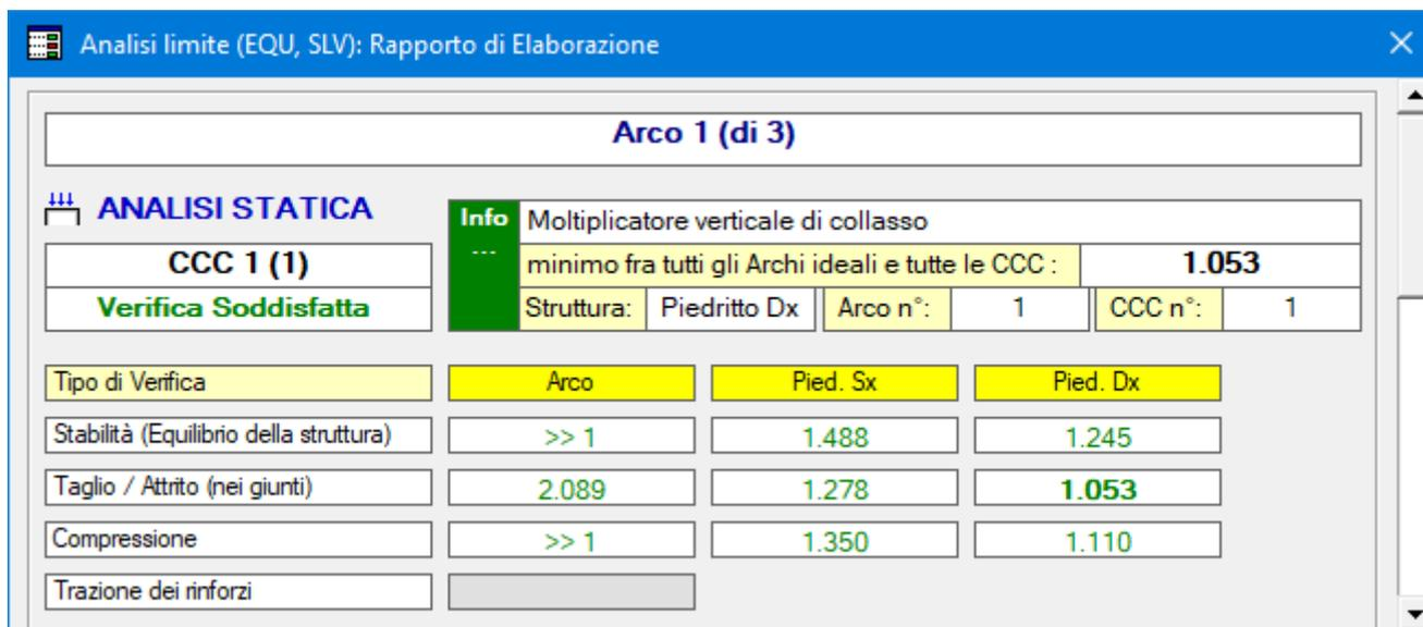
Fig. 2.4.24. Risultati definitivi per il ponte obliquo con transito di mezzi pesanti
