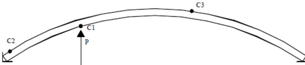
Fig. 2. Applicazione di una forza ad 1/4 della luce dell'arco per ottenere la configurazione danneggiata [1]
