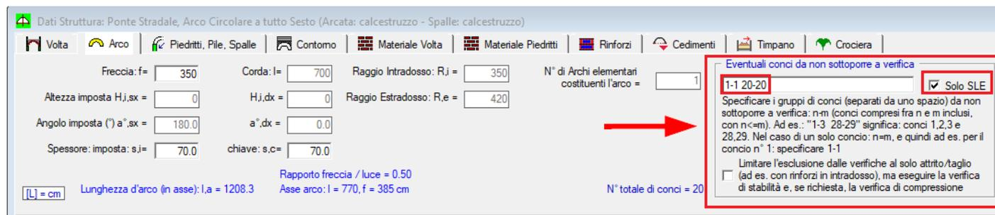
Fig. 3.4.6. Esclusione dalle verifiche dei conci iniziale e finale per il modello elastico
