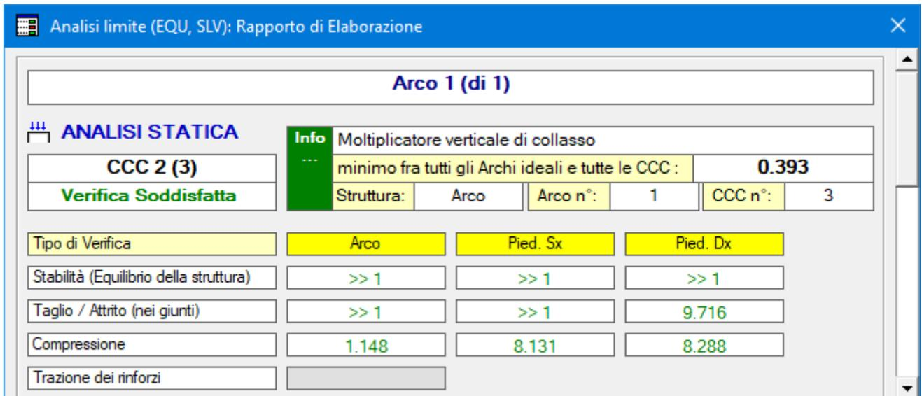
Fig. 2.1.32. Risultati Stato Attuale, Analisi Statica, CCC 2. Report sui moltiplicatori di collasso
