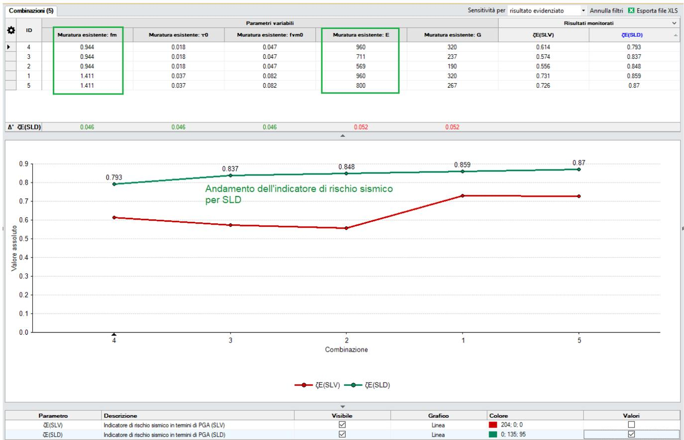
Fig. 10. Indicatore di rischio per lo stato limite SLD: risultati dell'Analisi Parametrica
