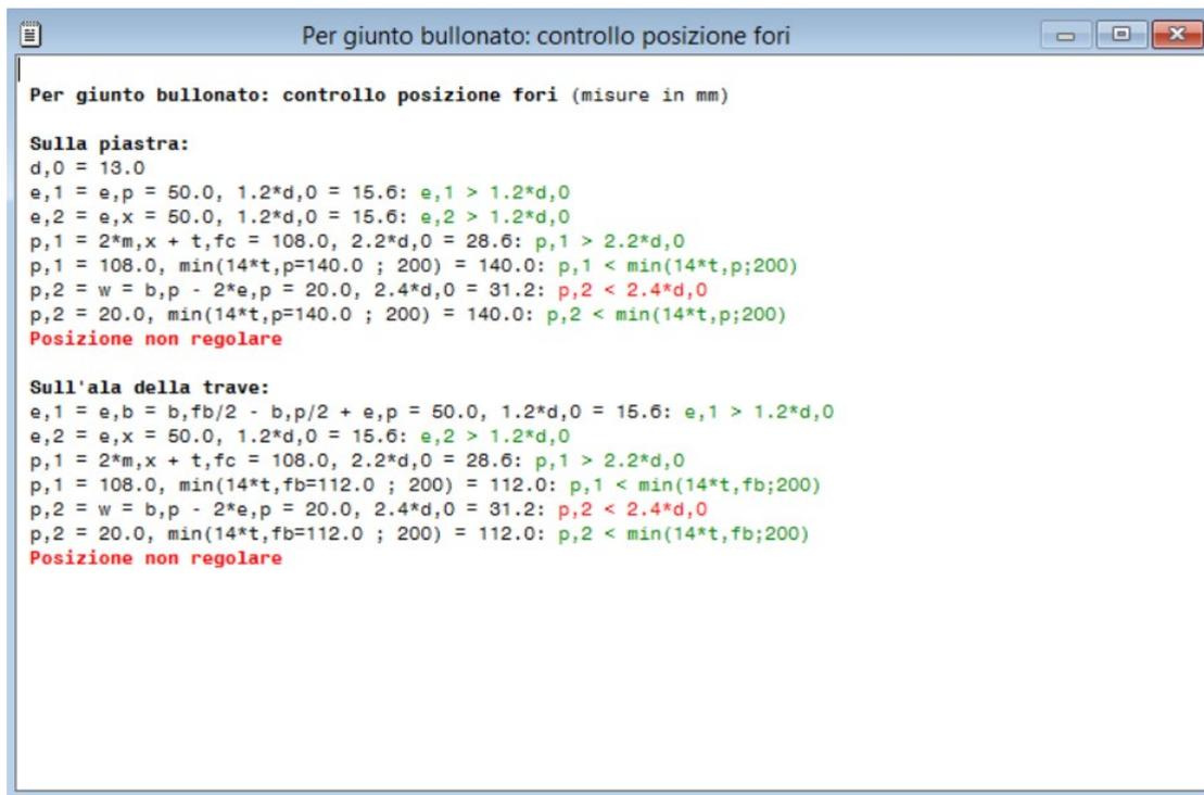
Fig. B.5.28. Giunto bullonato: controllo posizione fori
