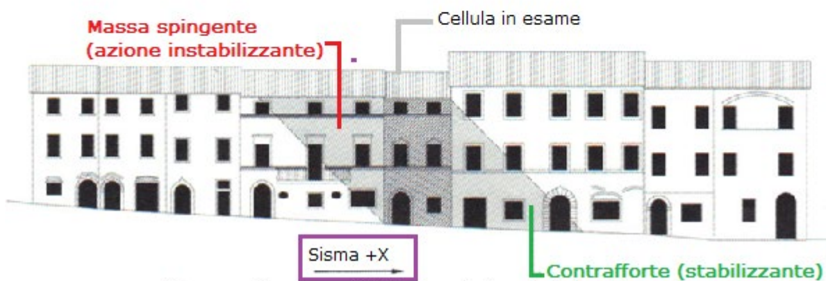
Cellule centrali: schema di diffusione delle azioni sismiche
