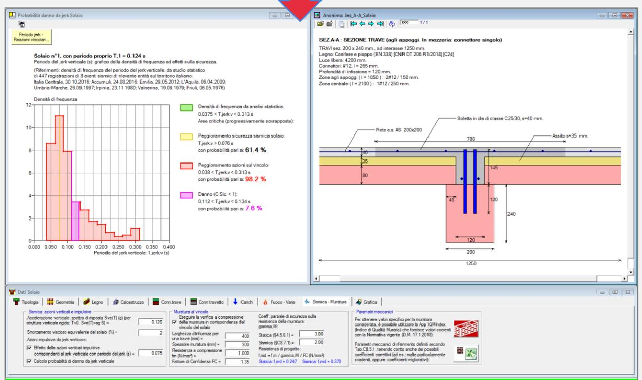
Aedes.SLC: Analisi degli effetti delle azioni sismiche impulsive sul nodo solaio - parete muraria
